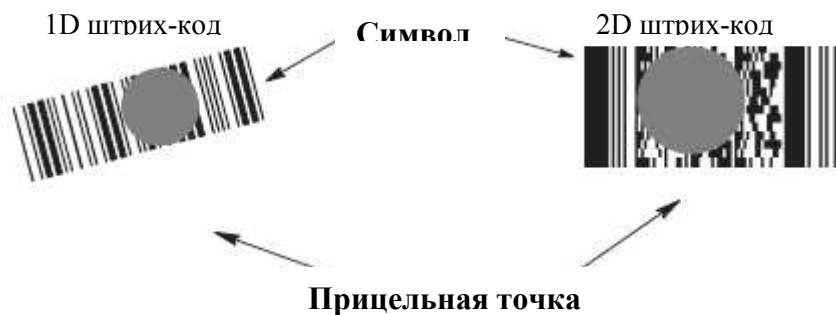
Рисунок 2-6 Ориентация сканирования при помощи прицельной точки
