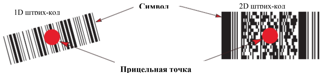
Рисунок 2-6 Ориентация сканирования при помощи прицельной точки
