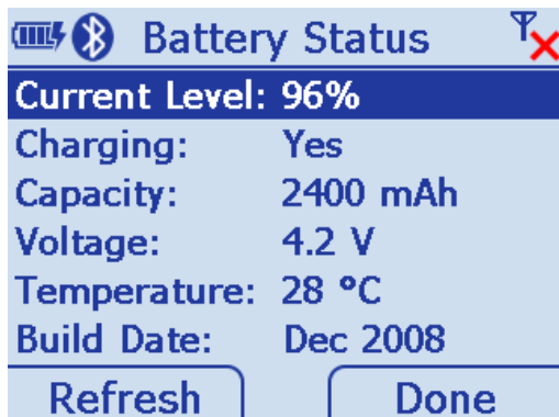
Рисунок 2-9 Экран состояния аккумулятора
